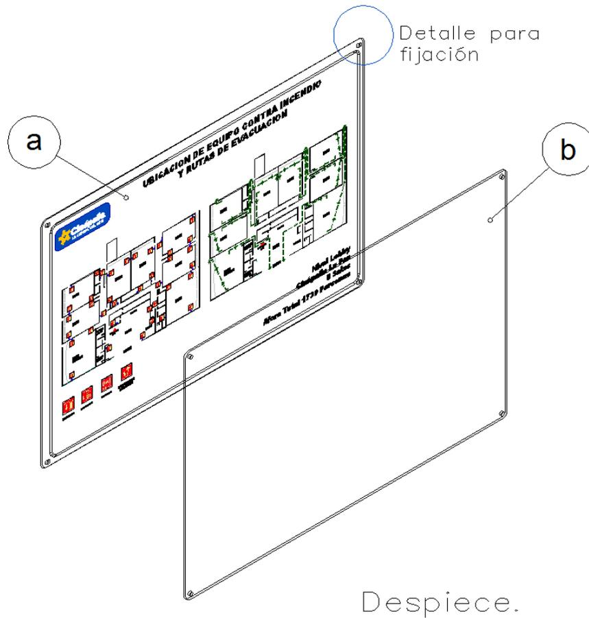
Detalle Fijación) Fijación a muro con 4 tornillos de cabeza plana, barrenos en los acrílicos de 1/4" de diámetro, en las 4 esquinas.
