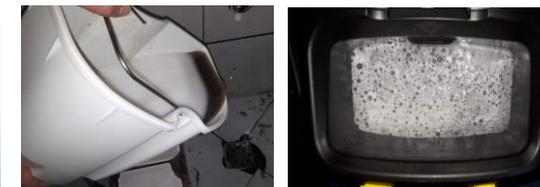
Quando o tanque de água suja estiver cheio, descartar toda a água no dosador.
