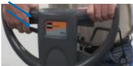
Pressionar a alavanca menor para ajustar a altura. A alavanca superior serve para ativar a máquina.
