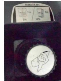
Montar a máquina colocando o disco e o reservatório. Abastecer o produto Taski Tapi puro (1 copo e ½ para 5 litros de água).
