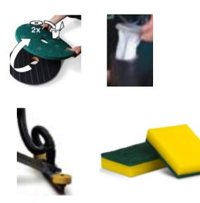
6. Após o uso da máquina, lavar o disco, mangueira, rodo e reservatórios com o produto Alpha HP 1:128 e esponja multiuso. Já o disco, enxaguar em água corrente.
