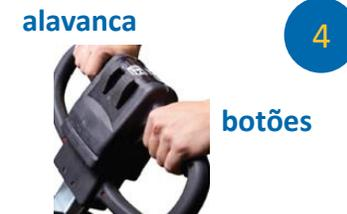
4. Liberar os dois botões e pressionar as alavancas para operar a máquina. Lavar o piso no sentido vai e vem. Quando o depósito de água estiver sujo, reabastecer com água limpa.
