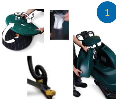
1. Montar a máquina colocando o disco vermelho, mangueira, rodo, reservatórios e filtro de tecido.
