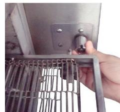
Insertar el pivote de la banda, alineando el tope en el orificio.
