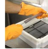
Retirar as mangueiras, compartimentos, conexões, forma de gelo e filtro de água para limpeza. Lavá-las seguindo o procedimento descrito no slide anterior.
