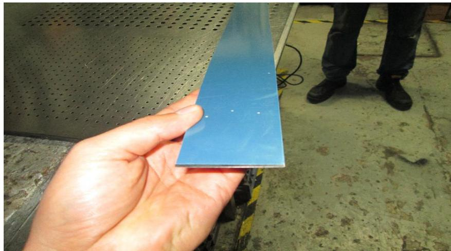
Use a chapa de aço carbono de bitola 22 com acabamento espelhado.
