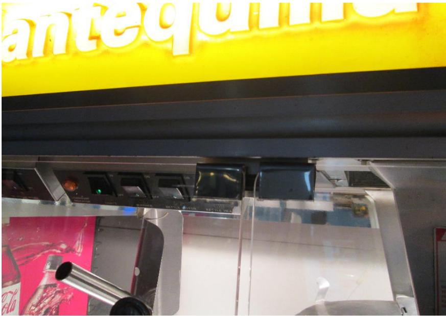
Passa cola na lateral superior da porta e coloque nesta lateral a folha de aço que foi cortada e dobrada, confirmando que a folha vai ficar na posição correta para entrar em contato com o feixe de imã e deixar secar.
