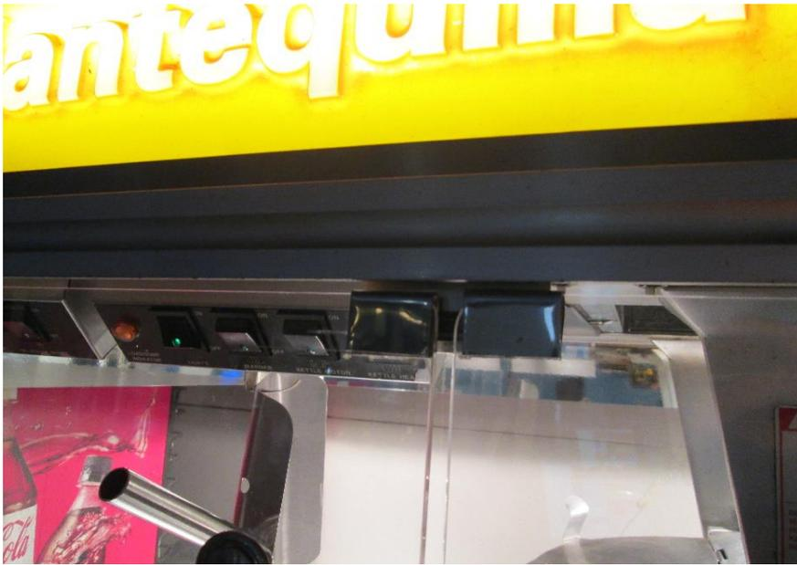
Colocar las laminas de acero una vez cortadas, colocar pegamento en la esquina de la puerta cuidando que se quede únicamente en la parte donde quedara la placa, fijar la placa y darle tiempo para el secado.
