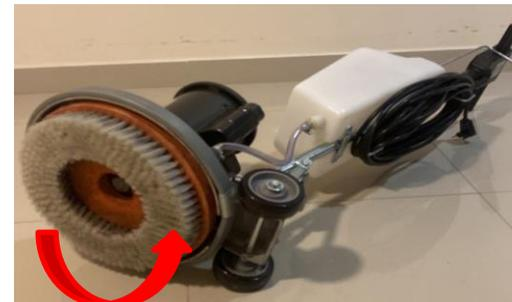
Inclinar a máquina na posição vertical e instalar o disco.
