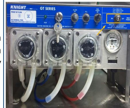
Encender la máquina, moviendo la perilla MAIN POWER, de derecha hacia la izquierda (OFF) hasta que tope (ON).
