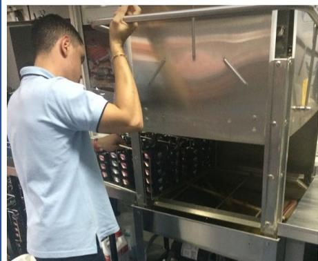
Colocar el cesto dentro de la máquina lava vajilla, verificando que quede bien centrada para impedir obstrucciones en el accionar de la máquina.
