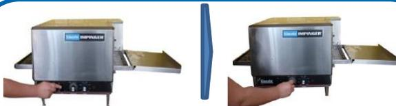
Apagar la gratinadora y cuando aplica, girar las perillas de tiempo y de temperatura hacia la izquierda, hasta el tope.
