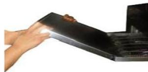
Colocar la bandeja de la gratinadora en posición vertical, y retirarla del equipo.
