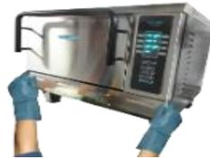
Colocar la piedra y la rejilla dentro del horno así como el panel inferior de la puerta del horno, limpiar el exterior el horno con un paño y quitarse los guantes.
