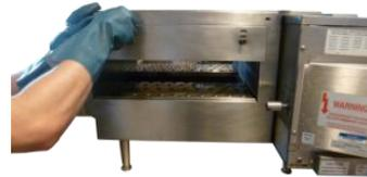
Colocar los paneles y pestañas con los tornillos de mariposa hasta apretar.
