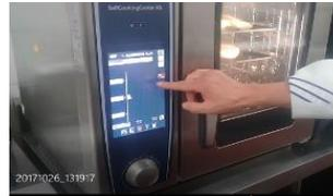
Verificar que el tiempo este ajustado a 1:10 min para el horno rational y 1 minuto para el turbo chef. Accionar el control y esperar el minuto y medio.
