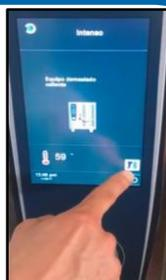
El horno indicara si se debe realizar un enfriamiento previo al lavado automático, si es sí, seleccionar el botón indicado y dejar la puerta del horno abierta, cuando el horno llegue a una temperatura de 49°C se detendrá el enfriamiento.
