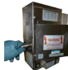
Empujar hasta el fondo el seguro de la gratinadora e insertar el pivote de la banda, soltar el seguro de la gratinadora para que quede fija la banda.
