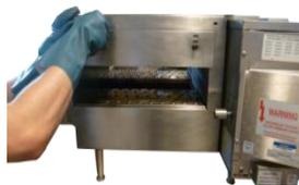
Colocar los paneles y pestañas con los tornillos de mariposa hasta apretar.
