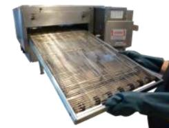
Introducir la banda en la gratinadora, cuidando que el pivote de ensamble quede del lado derecho trasero.
