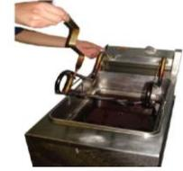
Encender la freidora, girando la perilla de la temperatura hacia la derecha y fijándola a 180°C o 350°F.
