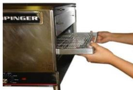
Colocar la banda dentro de la gratinadora cuidando que el pivote de ensamble quede del lado derecho.
