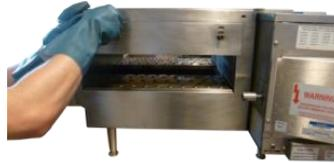
Colocar los paneles y pestañas con los tornillos de mariposa hasta apretar.
