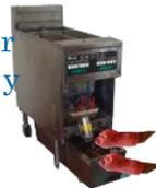
Abrir la puerta inferior de la freidora y jalar el cajón de filtro a la mitad.
