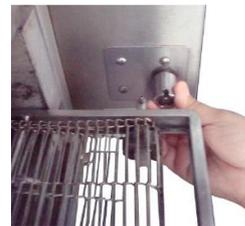
Insertar el pivote de la banda, alineando el tope en el orificio.
