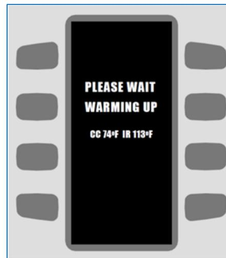
Se mostrará el mensaje "Warming Up" para el precalentado y cuando la temperatura del horno alcance la predefinida, el horno mostrará el mensaje "Ready to Cook" y sonará una alarma. Inmediatamente se desplegará el menú de programación para empezar a utilizarlo.
