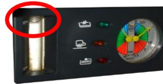
Verificar que el indicador del auto nivel de agua esté apagado y el nivel de la caldera en el máximo nivel.
