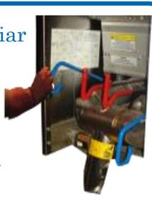
Con una cubeta vaciar agua limpia en el contenedor para enjuagarlo y, una vez que se vacíe el contenedor, subir la válvula de drenaje.
