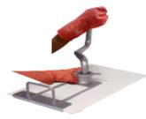
Doblar el extremo superior del papel filtro e insertar el tubo del filtro en la rejilla metálica.
