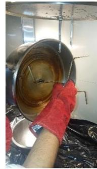
Levantar la tapa de la olla, jalando la palanca hacia arriba y retirar el agitador presionando el seguro.
