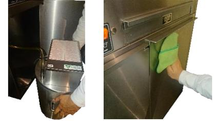
Meter nuevamente la lata de aceite y la bomba, colocar nuevamente las puertas del compartimento inferior y limpiarlas con un **pañó verde** y **Desengrasante. Break Up.**
