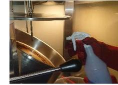
Con el atomizador para **High Temp** (este debe contener 200 mililitros de **High Temp**), rociar producto en toda la superficie de la olla, incluyendo a la tapa y las paredes.
