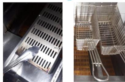
Colocar a placa protetora da resistência usando o pegador. Em seguida, os cestos de fritura nas cubas.
