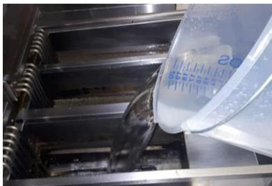
Após realizar o descarte do óleo, adicionar em cada cuba de fritura 15 litros de água limpa.
