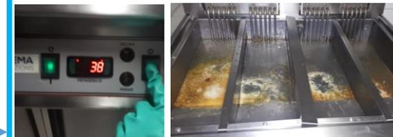
Ligar a fritadeira e deixar atingir uma temperatura de 38°C. Após, desligar o equipamento e manter a solução por 15 minutos de molho.
