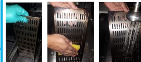
Retirar a placa protetora da resistência e lavar na pia com o produto suma break up e esponja. Após, enxaguar e deixar secando livremente.
