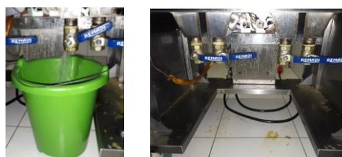
Pegar um balde para auxiliar a drenagem da água suja (dreno localizado na parte inferior da fritadeira).
