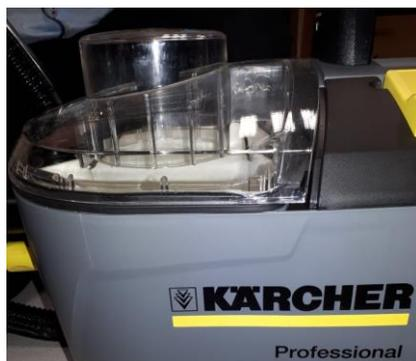
Colocar a tampa acrílica (tampa sucção de água suja).
