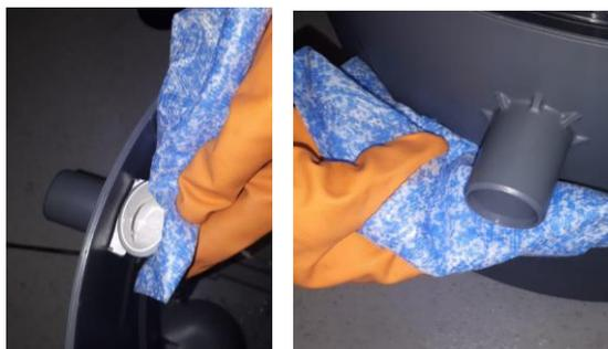
Limpar as áreas de sucção do equipamento com o Alpha HP 1:128 com a ajudar do pano azul.
