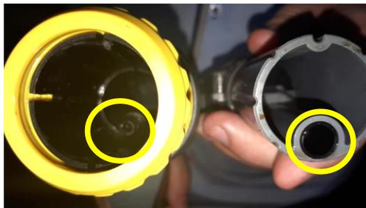
**ATENÇÃO:** Os encaixes internos devem estar na mesma direção, para que não ocorra vazamento.
