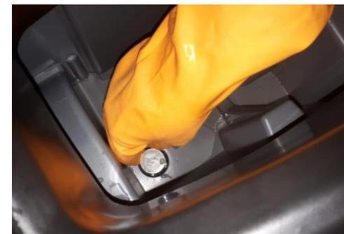
Retirar o filtro de solução e realizar a limpeza usando o produto Alpha HP 1:128.
