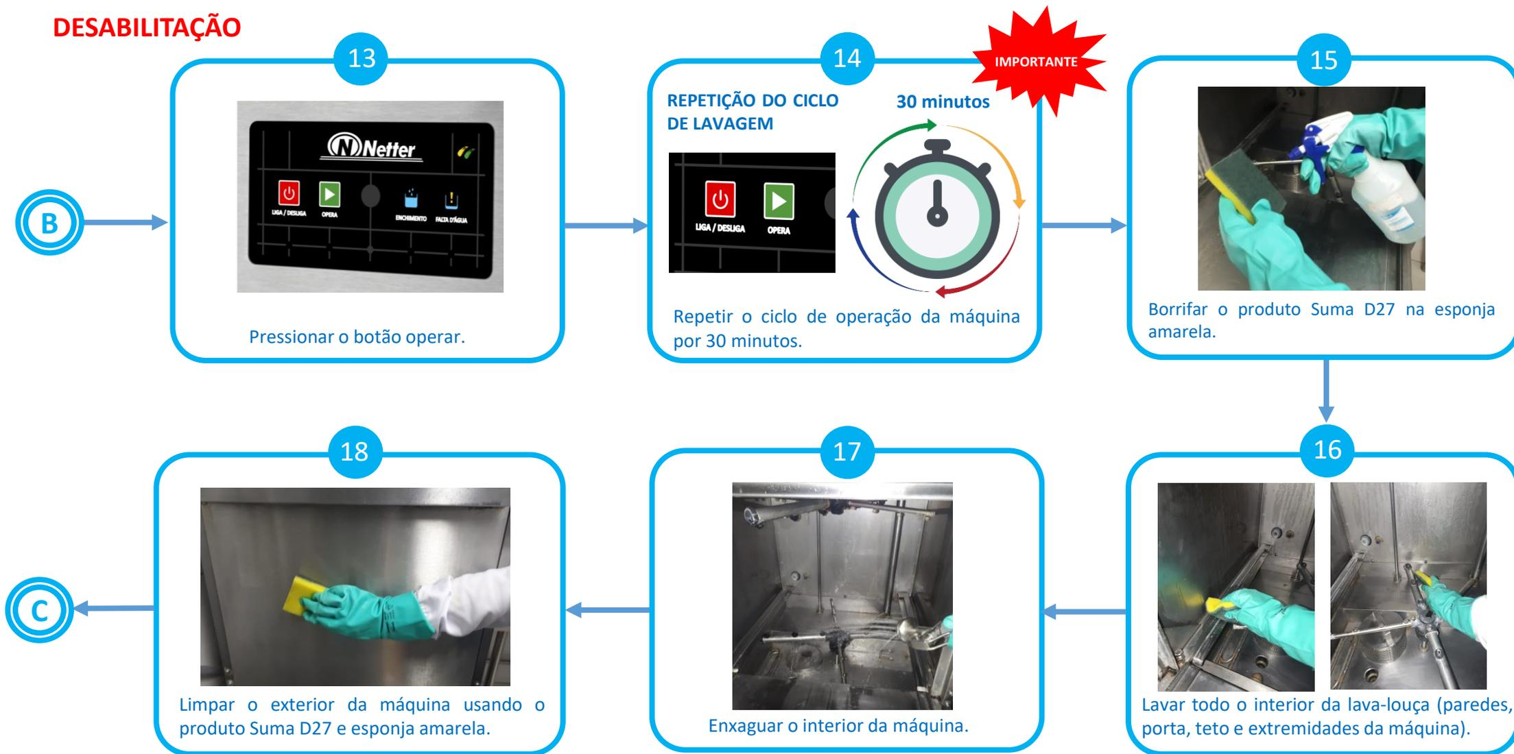
**NOTA:** É MUITO IMPORTANTE que o tempo de operação da máquina seja respeitado para obter melhor resultado na desincrustação do equipamento.
