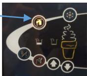
Despejar água nos reservatórios com uso de um balde e pressionar o botão **Lavar** para limpar não somente os reservatórios, como também, a parte interior da porta da máquina de sorvete.
