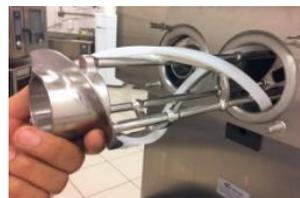
Retirar as lâminas de raspagem e o anel frontal do batedor.
