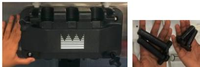
Retirar a porta do cilindro no respectivo lugar (conforme indicado na imagem). Para isso, deve desparafusar em formato de x para que a peça não caia.
