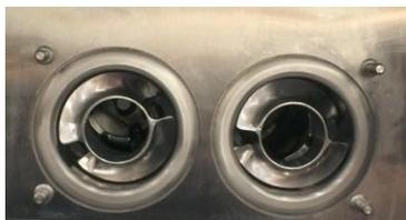
Encaixar o batedor no cilindro de congelamento, conforme indicado na imagem.
