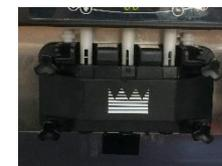
Encaixar as válvulas de extração no devido lugar (conforme indicado na imagem). Obs.: O anel da cor preta deve ser encaixado no meio.
