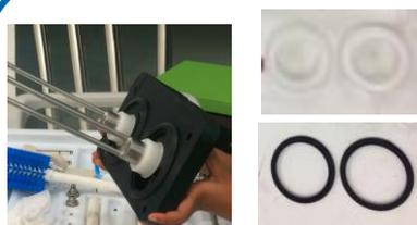
Colocar o anel preto e branco na porta do cilindro e aplicar uma camada uniforme de lubrificante (equivalente ao tamanho de uma ervilha) sobre a porta.
