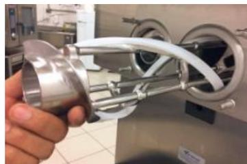
Encaixar as lâminas de raspagem e o anel frontal no batedor.
