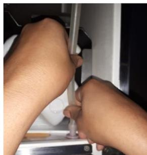
Acomodar os galões no compartimento respeitando a padronização de sabores. Conectar a mangueira na máquina. Em seguida, engatar o encaixe do bico.
