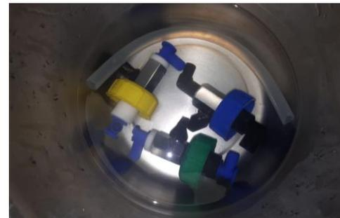
Imergir os bicos (drenagem de xarope) e mangueiras do equipamento na solução do Sumaveg, deixá-los agindo por 15 minutos.
