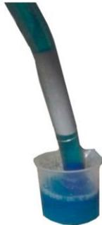
Accionar la salida de producto, oprimiendo el botón del dispensador y manteniendo la manguera que dosifica el producto en el vaso medidor. (2)
