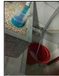
Para realizar la verificación de la concentración de químico, se debe dejar la manguera que lleva el producto al dispensador en el vaso medidor, hasta que el químico se acabe, y en ese momento, e inmediatamente dejar de accionar la salida de producto en el dispensador para que la medición sea correcta.
