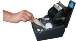
Introducir el nuevo rollo y dejar una parte del extremo del papel fuera del orificio de la impresora.
