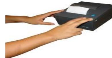
Cerrar la tapa de la impresora presionando hasta que ensamble.
