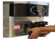
Colocar la puerta introduciendo las barras en los orificios de la máquina de helados.
