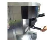
Colocar las bandejas de goteo laterales y central de la máquina de helados
