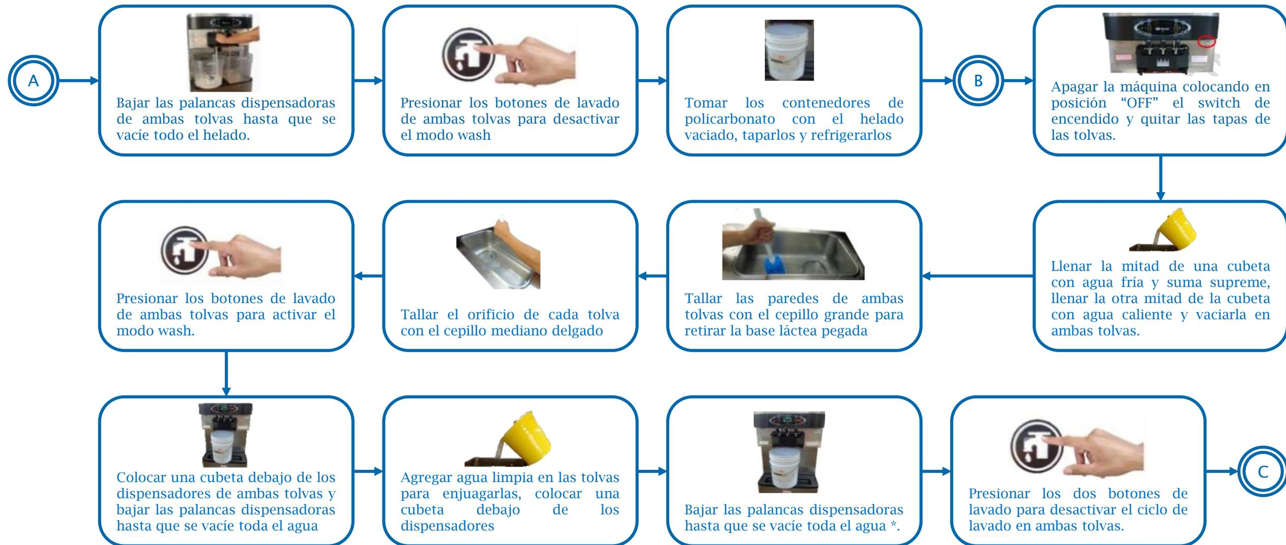
Nota: \*Bajar las palancas dispensadoras hasta que vacíe toda el agua, esta debe salir limpia y clara sino se debe repetir el paso.
