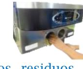
Retirar los residuos de helado con una fibra esponja utilizando únicamente el lado de la esponja para no rallar el equipo
