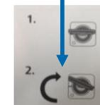
Abrir o dispenser por meio da chave, e em seguida, pressionar para baixo o local onde foi inserida a chave para abrir o equipamento.
