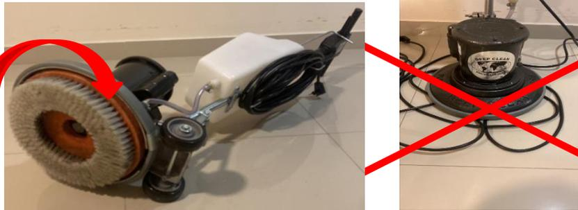
Retire o disco girando no sentido horário e enrole corretamente o cabo de energia no suporte da máquina.
