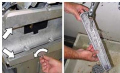
Se necessário, limpar as sapatas dianteira e traseira do aspirador com o produto Suma D27 e esponja. Depois, enxaguar na água corrente.
