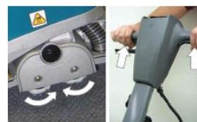
Inclinar a máquina levemente para trás, para então, puxar o gatilho de ativação por 60 segundos para molhar os rolos. Depois disso, ligar a máquina.
