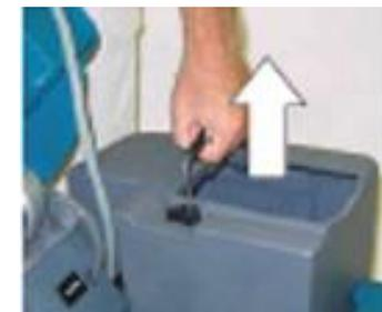
Levantar a tampa e retire o depósito de água .
