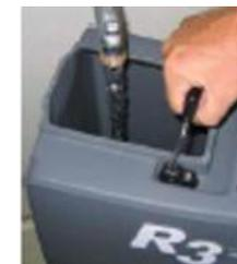
Encher o depósito com água limpa (cerca de 19 litros de água).
