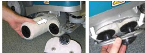
Caso os rolos precisam ser trocados, seguir o procedimento de retirada e encaixe dos rolos no *slide* 4.
