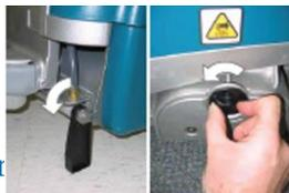
Levar a máquina para a posição de armazenamento do carpete retirando o prato dos rolos. Depois, gire o botão de fixação dos rolos no sentido anti horário para retirar os pratos e os rolos antigos.
