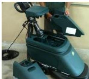
Manter o depósito e o tanque sempre limpo. Lavar internamente com o produto Alpha HP e esponja multiuso. Depois, enxaguá-los na água corrente.
