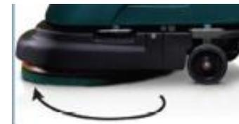
Retirar o disco para enxague. Enxaguar o disco na água corrente e deixar secá-lo.
