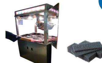
Utilizar uma esponja abrasiva e esfregar teto e local onde ficam os filtros com uso do borrifador Suma Break up já diluído.
