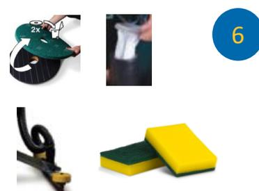
6 Após o uso da máquina, lavar o disco, mangueira, rodo e reservatórios com o produto Alpha HP 1:128 e esponja multiuso. Já o disco, enxaguar em água corrente.
