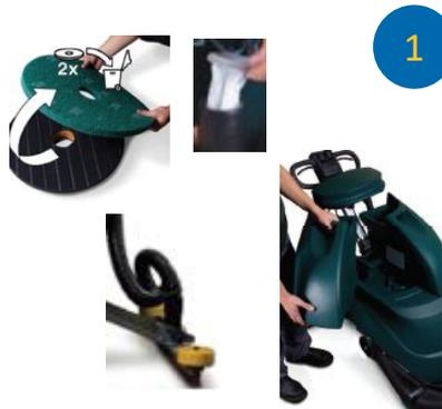
1 Montar a máquina colocando o disco vermelho ou branco, mangueira, rodo, reservatórios e filtro de tecido
