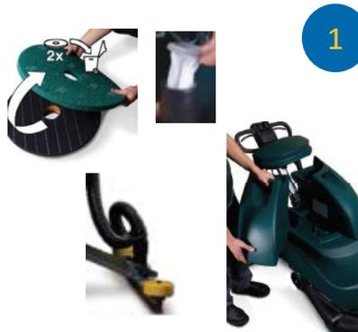
1. Montar a máquina colocando o disco, mangueira, rodo, reservatórios e filtro de tecido
