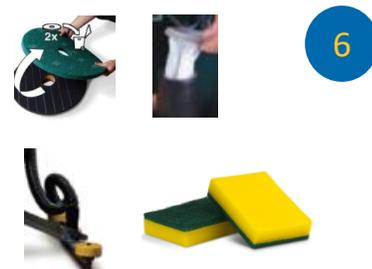
6. Após o uso da máquina, lavar o disco, mangueira, rodo e rservatórios com o produto Alpha HP 1:128 e esponja multiuso. Já o disco, enxaguar em água corrente.
