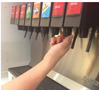
Difusores y boquillas de torres de gaseosa
