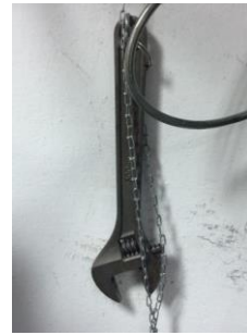
Llave para manipular conexiones de cilindros de CO 2
