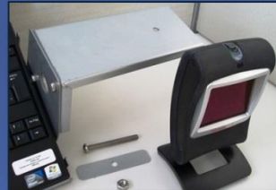
Piezas para la instalación del scanner lector.
