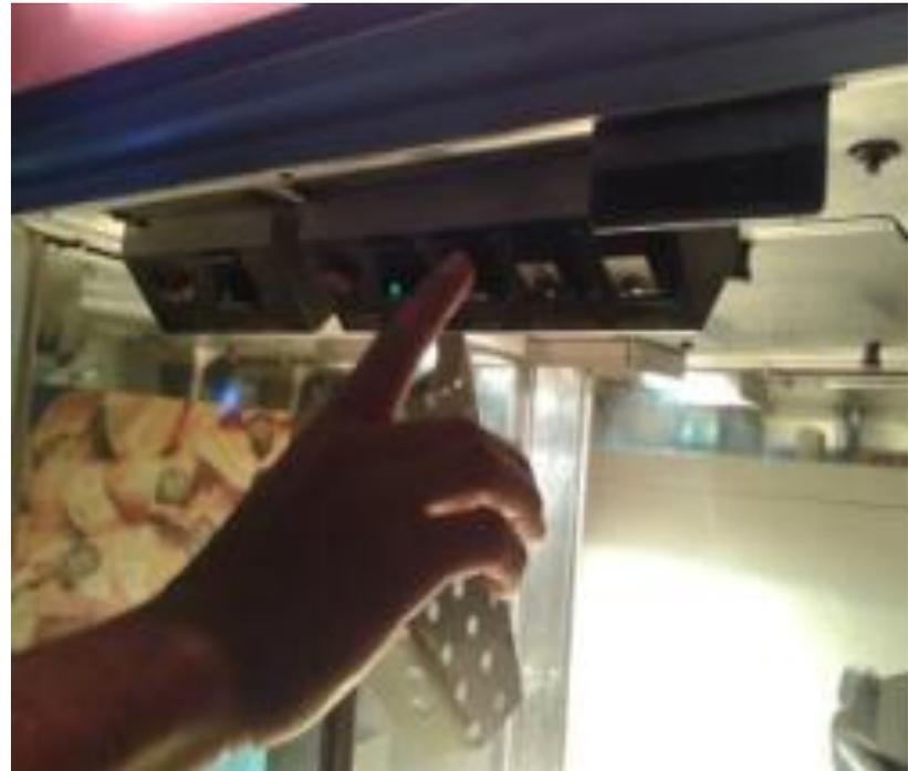
**Paso 3-** Retirar los tres tornillos que se encuentran en la tapa de la resistencia en el refractario de palomitas.
