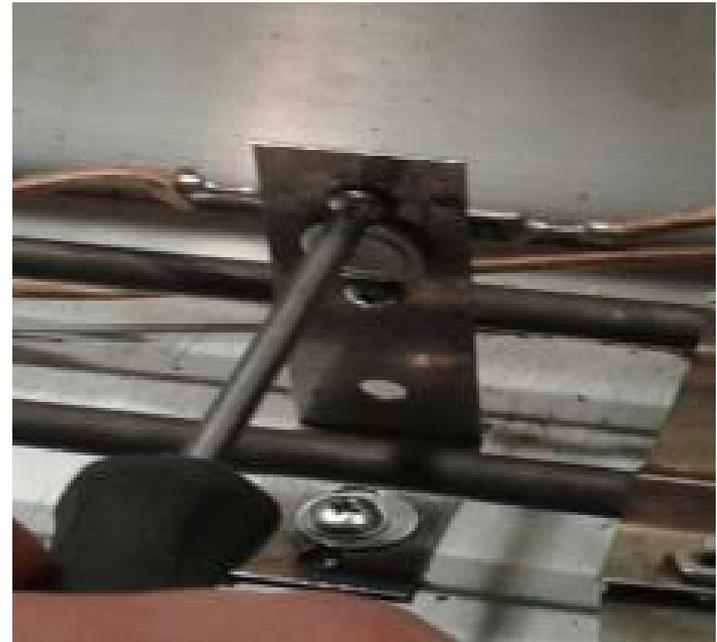
**Passo 5:** O termostato tem dois terminais de alimentação, é necessário removê-los para para remover o termostato.
