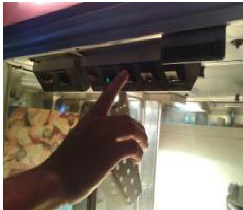
**Passo 3:** Desparafusar os três parafusos localizados na parte superior da resistência do recipiente inferior da pipoqueira.
