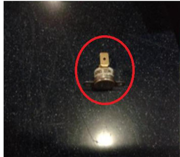
O Termostato de Baquelite é de cor preta e o de Porcelana deve ter um revestimento de cor branca, que é um revestimento cerâmico na peça.
